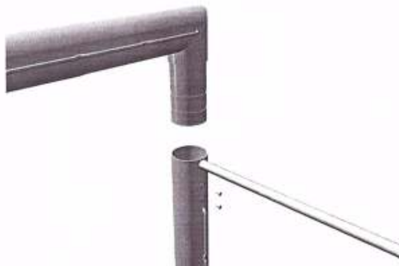
Рис.5 Рисунок крепления перекладины к штанге
