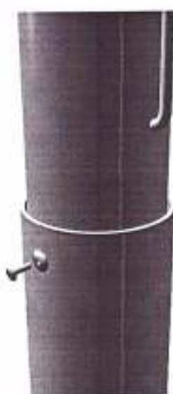
Рис.6 Рисунок крепления штанги в стакане.
